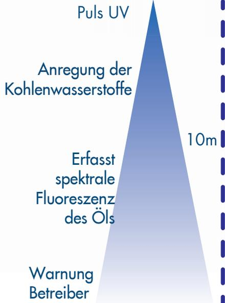
Der **ROW** (Remote Optical Watcher) ist ein berührungsloser Sensor zur Erkennung von Öl/Kohlenwasserstoffen auf Oberflächen. Hochgenau und wartungsarm, erkennt der ROW und warnt vor Ölverschmutzungen. Das System bietet eine 24/7 Überwachung in Zu- und Ablaufbereich von Wasseroberflächen.
